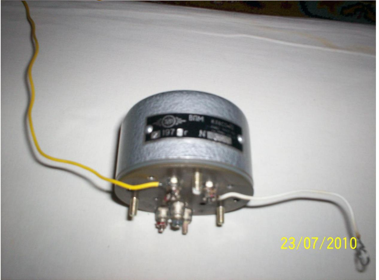
С выхода соленоида получил сигнал с частотой работы прерывателя 80Гц.
