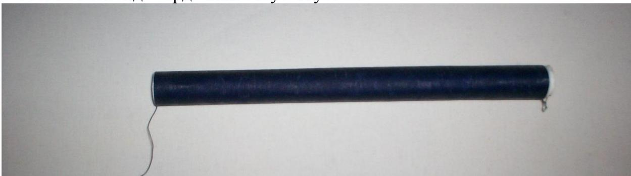
Поверх этого соленоида намотал телефонный провод спаянный с одного конца, на всю длину. Получилась обмотка типа Купер. Затем сверху прилепил конденсатор (ёлочная игрушка покрытая фольгой).
